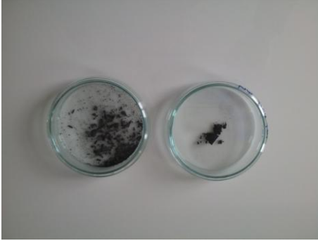
Şekil 3.6. % 10 metal oksit içeren ÇDKNT'ler (solda) ve HCl ile asit oksidasyonu uygulanan ÇDKNT'ler (sağda)
