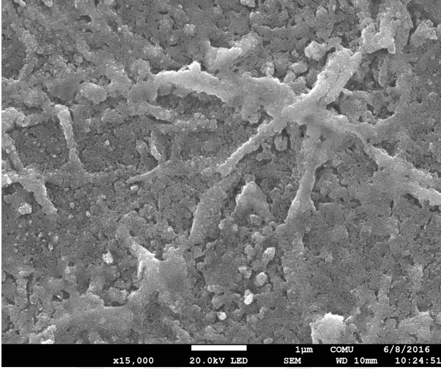
Şekil 4.28. CuO:In(%12) filmlerinin 15000 kez büyütülmüş SEM fotoğrafları.
