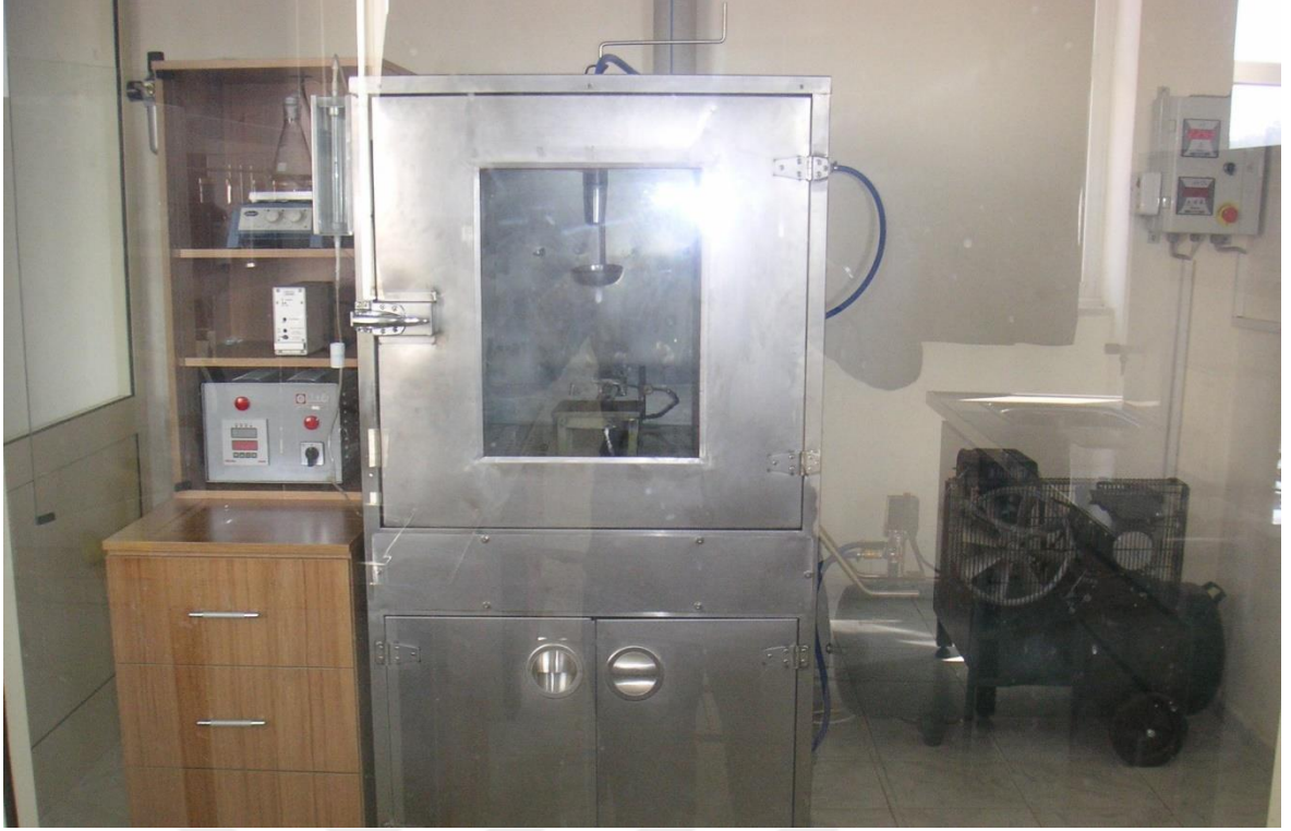
Şekil 3.4. Ultrasonik spray pyrolysis tekniğinin fotoğrafı.
