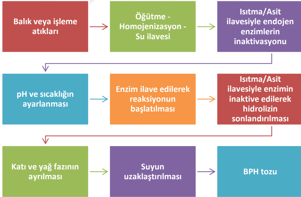
Şekil 2.4. Enzimatik balık protein hidrolizatı üretimi genel akış şeması
