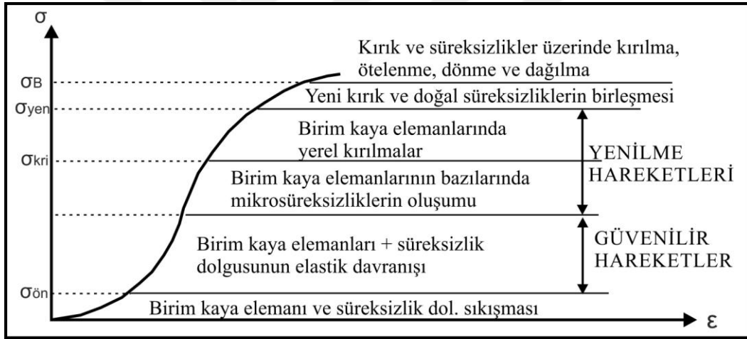
Şekil 1.1. Sıkışma altında meydana gelen yenilme safhaları (Kılıç, 2005)
