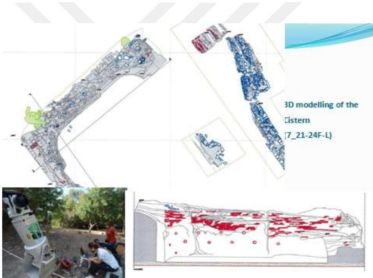
Resim 3.43. Büyük sarnıçta mimari plan çıkarma çalışmaları.
