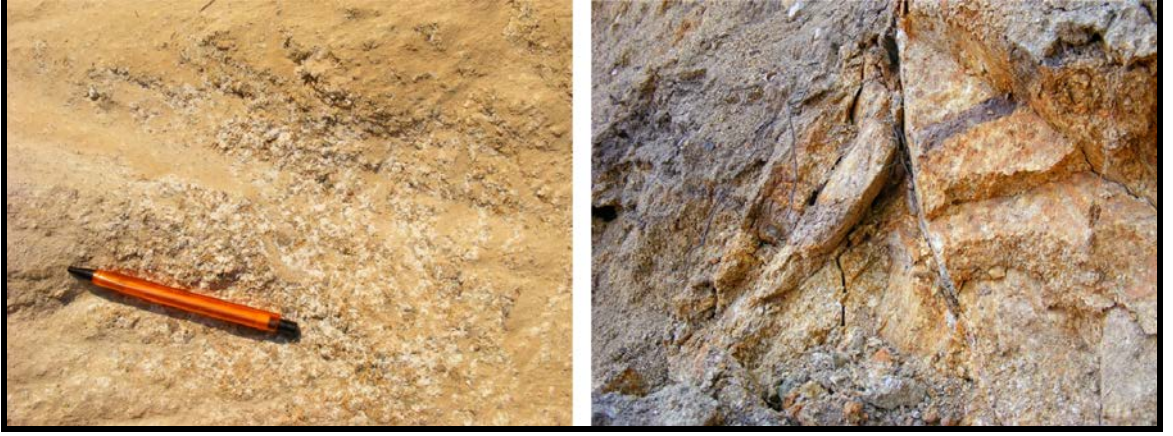
Şekil 4.25. Laledağ granodiyoritinde ileri alterasyon ile birlikte gözlenen arenitleşme ve kırık-çatlaklar (UTM: 488782 D, 4459360 K).
