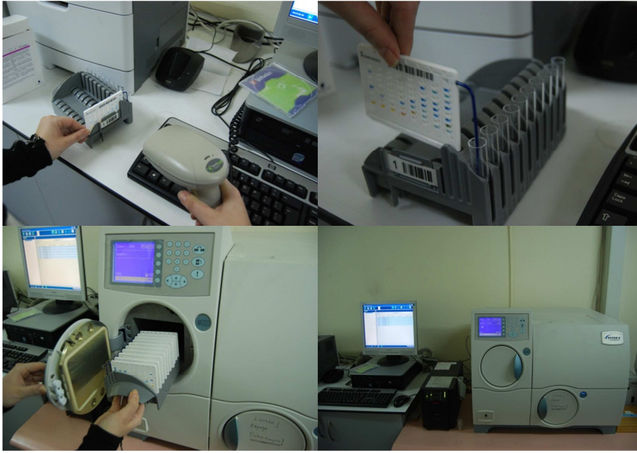
Şekil 7. Vitek 2 Compact cihazında izolatların identifikasyonu.
