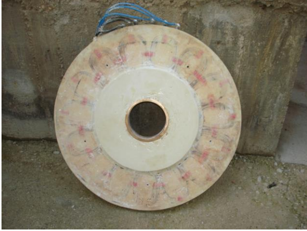
Şekil 4.4. Stator bobinlerinin dış ortamdan izole edilmesi için kalıp içerisine alınması gösterimi
