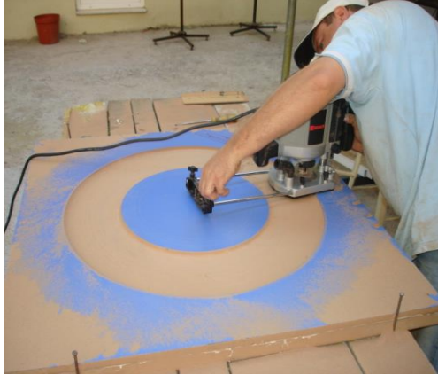
Şekil 4.3. (a)Titreşim ve bağlantının yapılabilmesi için bobin protolin kalıbının hazırlanması ve (b) Bobin gruplarının sarılması
