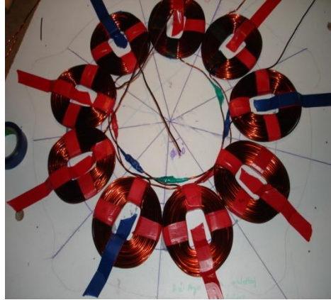
Şekil 4.3. (a)Titreşim ve bağlantının yapılabilmesi için bobin protolin kalıbının hazırlanması ve (b) Bobin gruplarının sarılması
