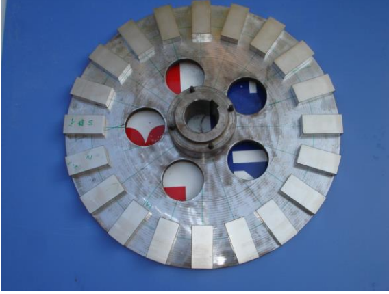
Şekil 4.2. Rüzgâr türbininde kullanılan alternatörün rotor kısmındaki mıknatısların yerleştirilmesinin gösterimi
