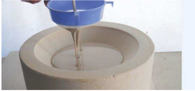
Resim 2.35. Çamurun süzülerek döküm yapılması
