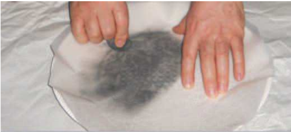
Resim 2.47. Desenin kömür tozu yardımıyla porselen bisküviye baskısı
