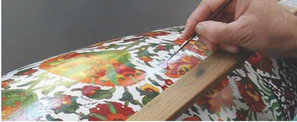
Resim 1.22. Porselen vazo üzerinde sırüstü dekorlama (Yıldız Çini ve Porselen)
