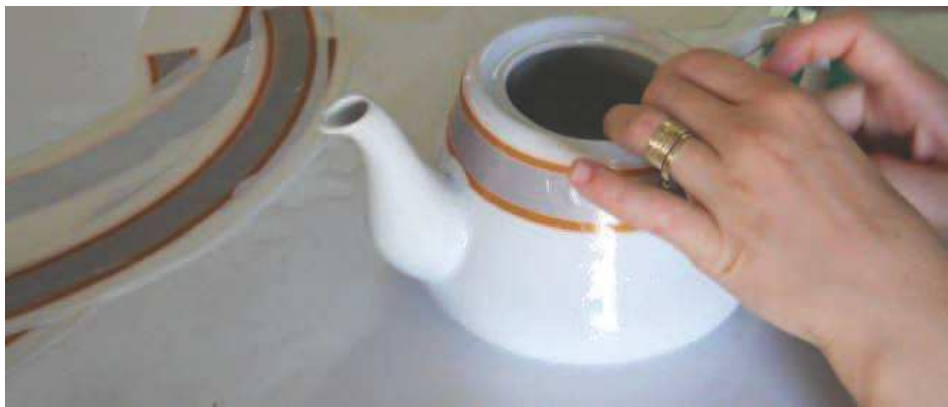
Resim 1.23. Demlik üzerine sulu çıkartma kâğıdının aktarılması (Zümrüt Porselen İşletmesi)
