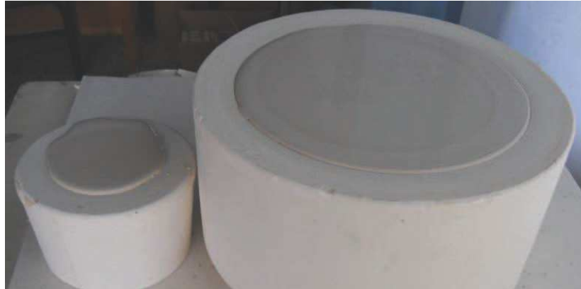
Resim 2.36. Çamurun kalıpta bir müddet bekletilmesi
