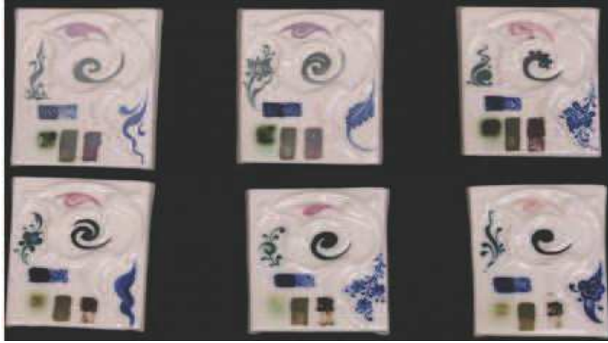
Resim 2.17. (1200-1225-1245-1275-1300-1325°C)'de fırınlanmış deneme plaka örnekler
