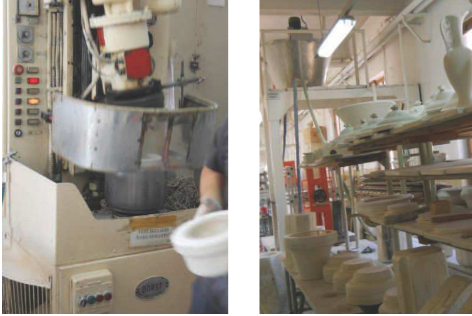
Resim 2.24. Presbaskı (solda) ve dökümhane (sağda) (Yıldız Çini ve Porselen)
