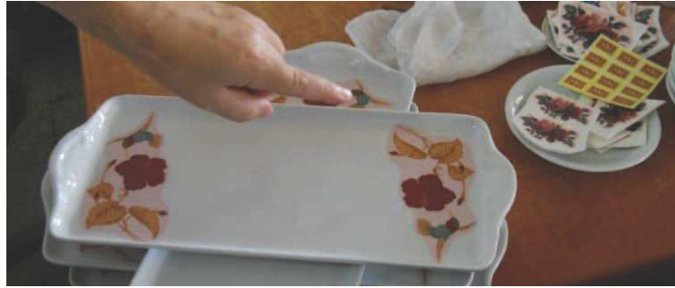
Resim 2.30. Çıkartma baskı desenlerin yapıştırılması, teknik dekor bölümü, (Yıldız Çini ve Porselen)
