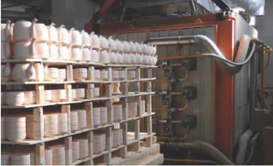
Resim 2.26. Doğalgazlı (1400 °C )’lik porselen fırını, (Zümrüt Porselen)
