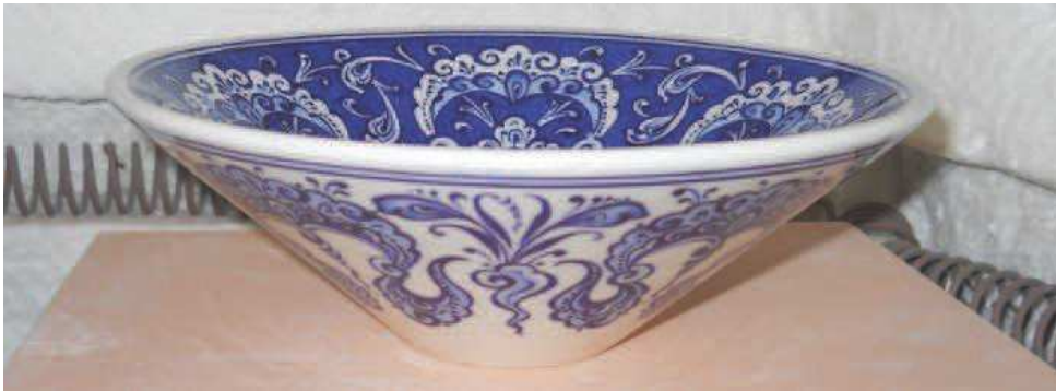
Resim 2.42. Dekorlanmış ve 1240°C'de sır pişirimi yapılmış formun son hali
