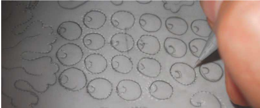
Resim 2.45. Desenin iğneyle delme işleminin yapılması
