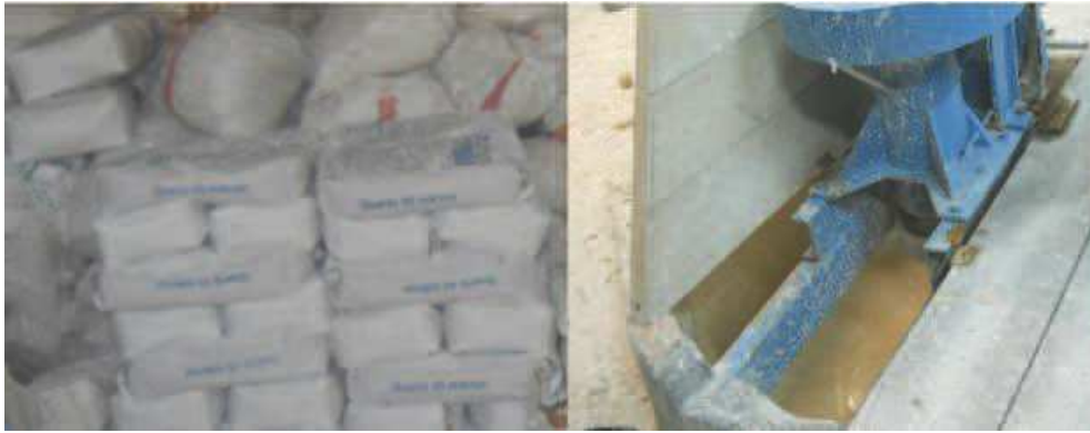
Resim 2.22. Hammaddeler ve çamurun hazırlanması, (Yıldız Çini ve Porselen)
