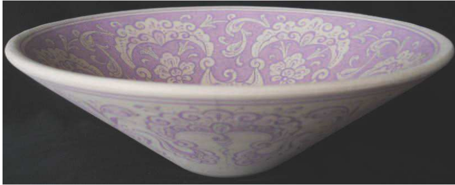
Resim 2.70. Porselen kâse tahrir ve boyaması yapılmış sırlanma öncesi görünümü.
