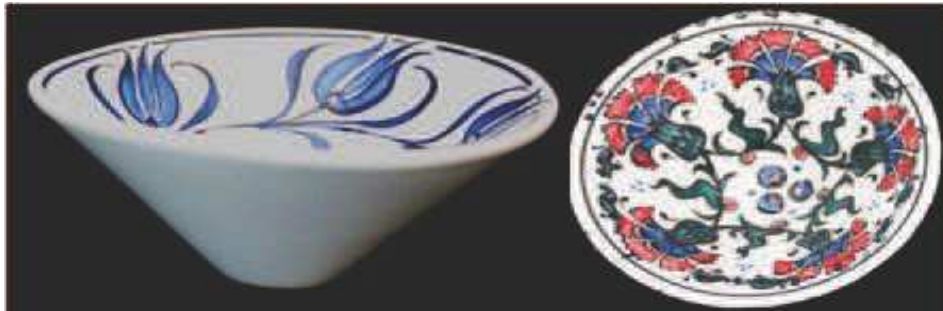
Resim 2.21. Sırlı pişim sonrası, normal ve hatalı sır çıkışlı kâseler 1260 °C
