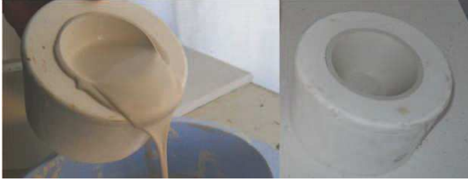
Resim 2.18. Kalıp döküm yöntemiyle şekillendirme
