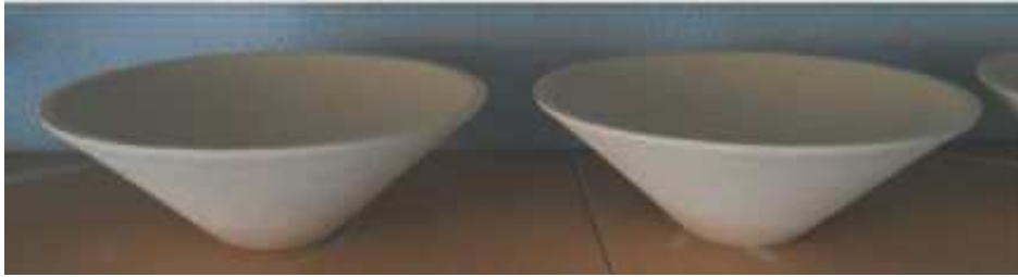
Resim 2.39. Alçı kalıptan çıkmış kurumaya bırakılmış ham bisküvi formlar
