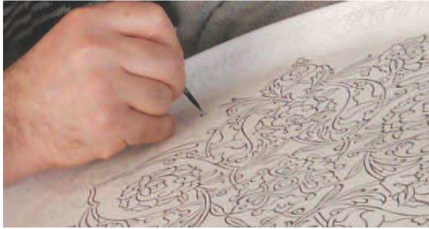
Resim 1.21. Sıraltı el dekoru, porselen yüzeyde desenin tahrirlenmesi
