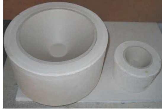
Resim 2.38. Çamurun kalıptan ayrılması için belli bir süre bekletilmesi
