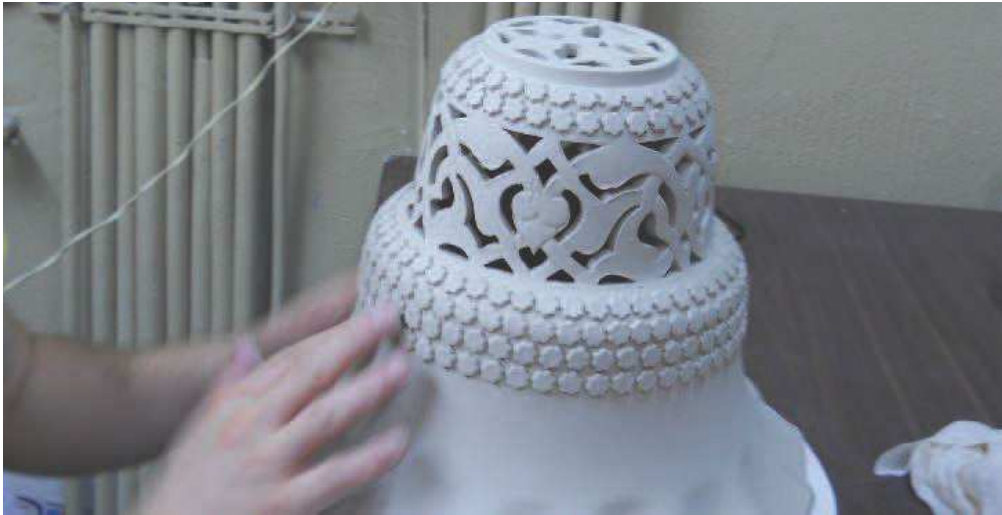
Resim 1.20. Porselen form üzerine ajur tekniği ve applike dekorunun yapılması, Yıldız Çini ve Porselen İşletmesi imalathanesindeki üretimden görünüm
